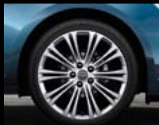
Točak od lake legure, 8 J x 19", dizajn sa više kraka, pneumatici 235/40 R 19 (RV4). 6
