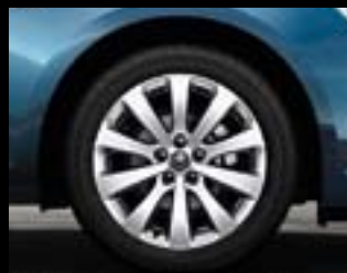
Točak od lake legure, 7 J x 17", dizajn sa više kraka, pneumatici 215/50 R 17 (PGQ). 8
