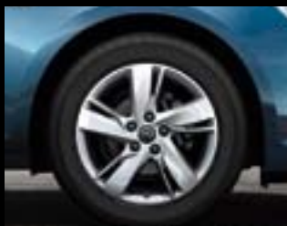
Točak od lake legure, 7 J x 17", dizajn sa 5 podeljenih kraka, pneumatici 215 (225)/50 R 17 (RTN). 7
