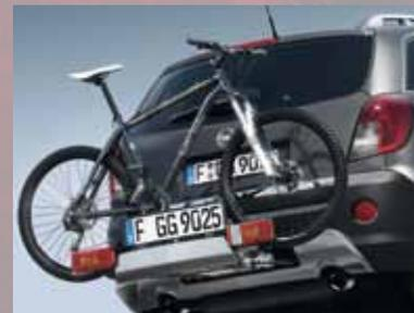
**FlexFix®-Fahrradträgersystem.** Vollständig in den hinteren Stoßfänger integriert, wartet praktisch unsichtbar auf seinen Einsatz. Dank der geringen Höhe lassen sich zwei Fahrräder mit wenigen Handgriffen befestigen.
