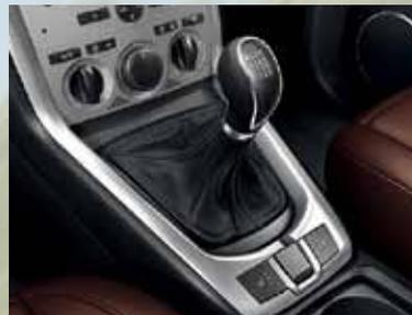
**6-Gang-Schaltgetriebe.** Perfekt abgestuft entsprechend der jeweiligen Motorisierung, sorgt das 6-Gang-Schaltgetriebe für hohen Fahrspaß bei niedrigem Verbrauch. Serienmäßig beim 2.4 ECOTEC® und bei den 2.2 CDTI ECOTEC®-Dieselaggregaten.
