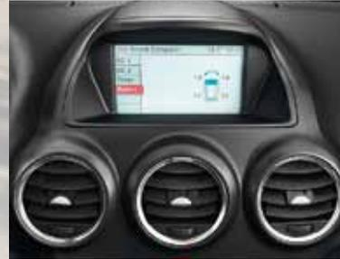
**Reifendruck-Kontrollsystem (TPMS).** Bei Druckverlust erfolgt eine automatische Warnmeldung mit Angabe des Rades auf dem Graphic Info Display bzw. Color Info Display.
