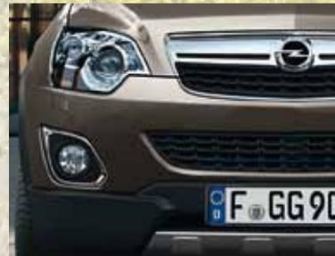
**Scheinwerfer.** Sehen und gesehen werden: In den Stoßfänger integrierte Halogen-Nebelscheinwerfer sind genauso serienmäßig wie die Halogen-Frontscheinwerfer mit Leuchtweitenregulierung. Xenon-Scheinwerfer mit Leuchtweitenregulierung und Hochdruck-Reinigungsanlage sind als Sonderausstattung erhältlich.
