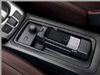
**Mobiltelefon-Vorbereitung.** Mit Sprachsteuerung und Bluetooth™-Schnittstelle. Liegt das Handy in der Station, ist es mit Infotainment-System, Lenkradfernbedienung und Graphic Info Display oder Color Info Display vernetzt.
