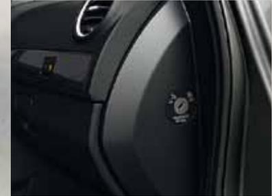
**Beifahrerairbag deaktivierbar.** Der Frontairbag auf der Beifahrerseite kann bei Nutzung eines Kindersitzes deaktiviert werden.
